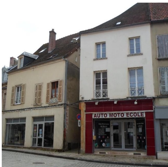
Façades en pan de bois enduit, sur lesquelles l'enduit peut être un enduit « chaux chanvre », améliorant légèrement l'isolation thermique.
